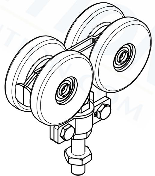
Monture avec support col de cygne, 4 roulements à billes avec un surmoulage en nylon chargé fibre de verre
