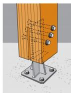
Les pieds de poteau en âme avec platine type PPSDT permettent la réalisation d'assemblages discrets et fiables. Leur conception en âme assure des charges au soulèvement.
