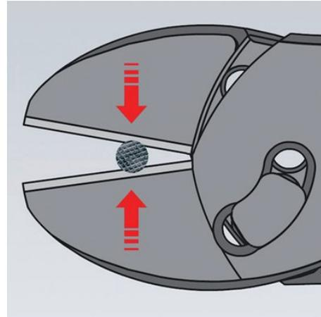
Entaillez tout d'abord le câble avec la pince KNIPEX TwinForce® jusqu'à ce que la force nécessaire de la main augmente fortement. Puis, ouvrez la pince et faites glisser vers l'arrière le fil au plus proche de l'axe de démultiplication en le maintenant dans l'encoche de coupe.
