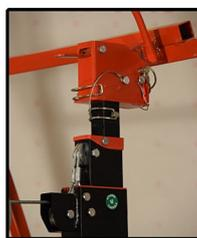
Vérouillage automatique de l'antenne en position horizontale
