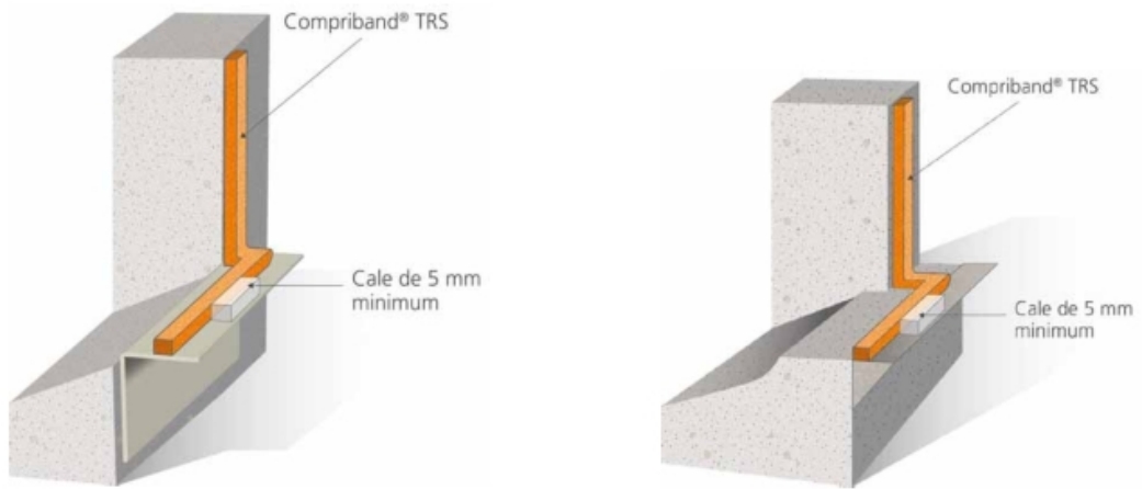
Croquis 13-1 : Pose sous appui de fenêtre
