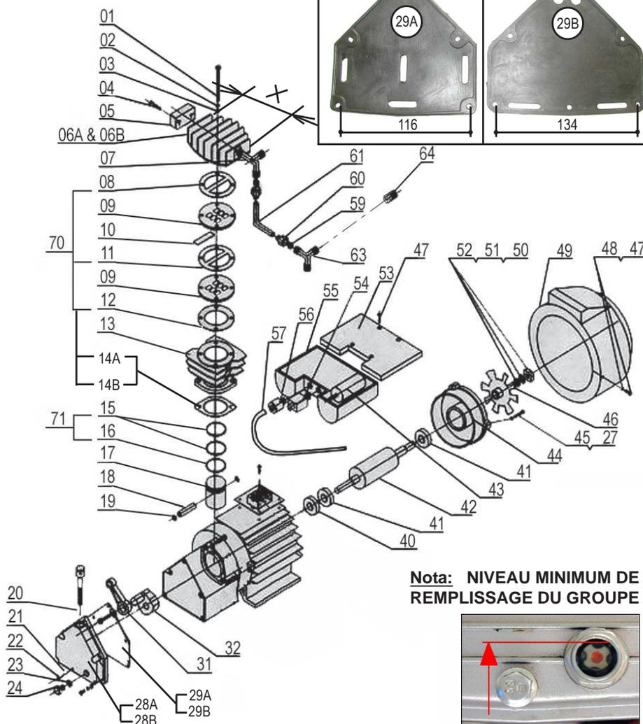
**IMPORTANT :** Pour commander les pièces détachées du cylindre de compression, préciser la référence de votre cylindre J2047 suivi du code . **Ex: Pour cylindre J2047: Joint de culasse code J2047008**
