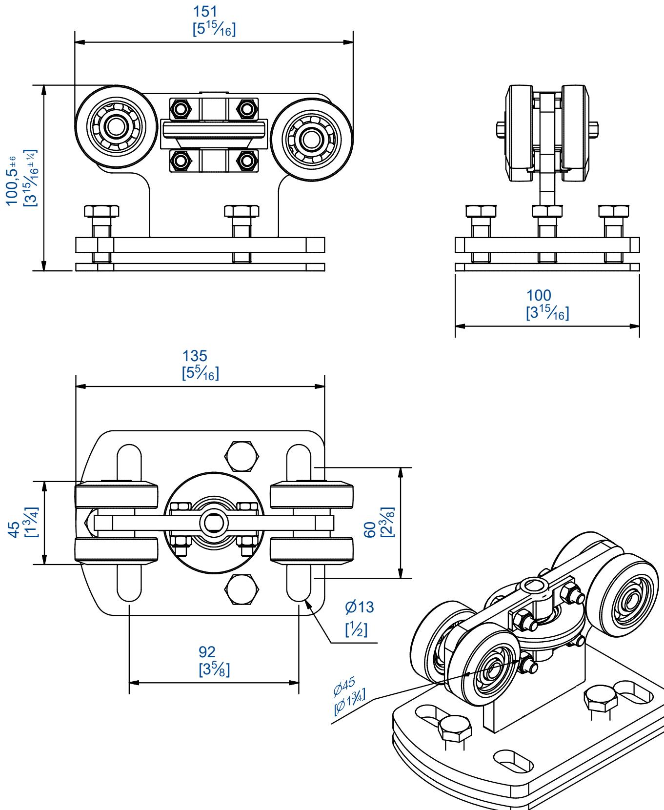
Monture équipée de 4 galets acier montés sur roulements à billes.
