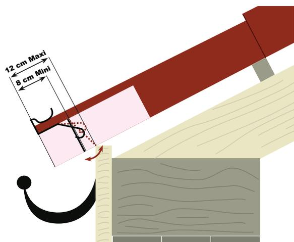
Le **PEGNALU**, **pliable** et **malléable**, s'adapte aux diverses formes intérieures des tuiles. Le clip est pliable également, ce qui lui permet d'absorber un débordement de tuiles variant de **8 cm** à **12 cm**. (voir schéma).
