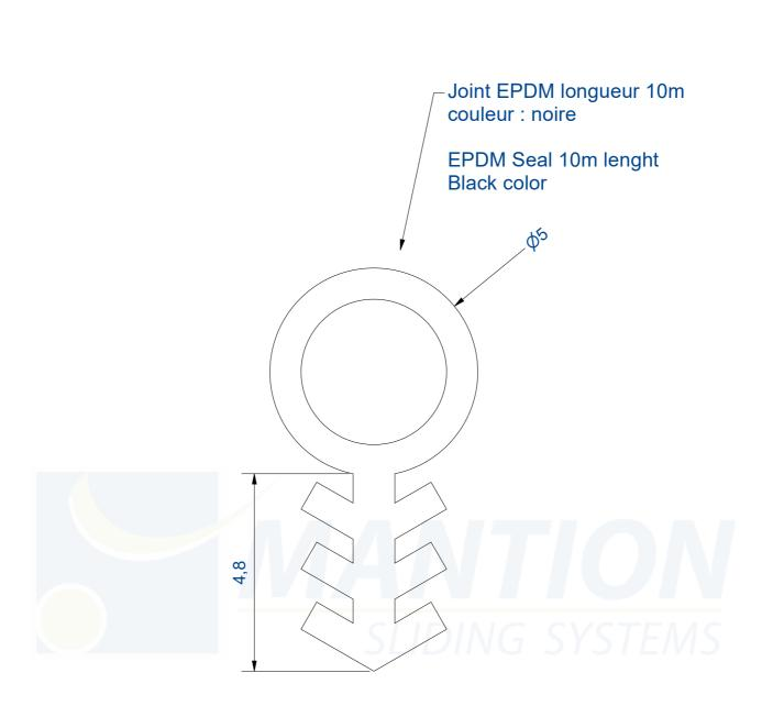
Rainure largeur 3mm / profondeur 5mm
