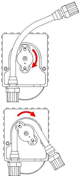
**FR** Positionner le raccord de gauche du nouveau tube péristaltique dans l'encoche prévue à cet effet. Faire attention à ce que la partie arrondie soit orientée vers l'intérieur. Tourner le porte-galet dans le sens horaire de façon à ce que le tube péristaltique se mette naturellement en place. Ne jamais tourner à contre-sens.
