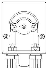
**FR** Insérer le raccord de droite dans l'encoche prévue. Positionner le couvercle sur la pompe et le fixer à l'aide des deux vis.
