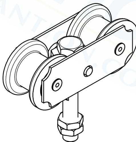
Monture pivotante avec 2 galets acier montés sur cage à rouleaux.
