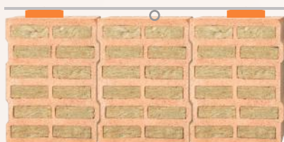
Finition plaque de plâtre collée par plots
