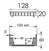
Caniveau longueur 0,5 m avec feuillure PVC avec 1 grille piscine PVC gris A15 encastrée avec emboîture à coller
