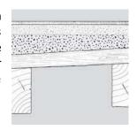
ragréage avec niveau intégré. Parallèlement à cette digue, à une distance égale à la longueur d'une règle d'égalisation, réaliser la même opération. Une fois les 2 digues réglées, l'épandage des granules peut commencer.
