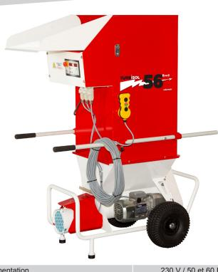
Alimentation 230 V / 50 et 60 Hz Courant maxi 11 A Puissance moteur 0,55 kW par chaîne Transmission Turbine 3300 L/min - 1400 W Pression 0.3 bar 0 à 28 sacs/h Débit ouate de cellulose 220 L Capacité de cuve 1 Filtre turbine aspiration Longueur tuyau produit Ø63 x 25 m Diamètre sortie produit 63 mm Roues gonflables Ø 300 Télécommande filaire 25 m - Marche / Arrêt Hauteur de chargement 122 cm 105 x 68 x 142 cm Dimensions (L x I x h) Poids 95 kg Niveau sonore 101 Lwa
