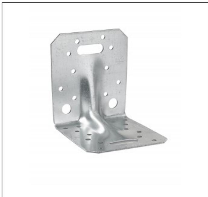
L'équerre renforcée ACRL10520 répond à des applications structurales dans la charpente et la maison à ossature bois. La présence des trous oblongs sur chaque aile permet un réglage latéral.
