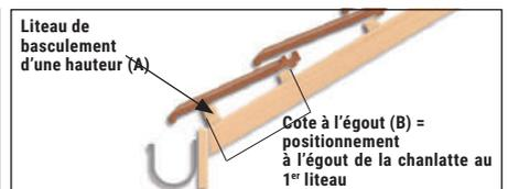
Afin de donner aux tuiles d'égout la même pente que celle des tuiles de plain carré, elles doivent reposer sur un basculement dont la hauteur dépasse le plan des liteaux d'une valeur "A" que l'on détermine en fonction de la cote à l'égout.
