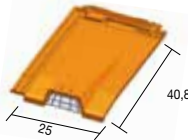
613 VPV Tuile châtière Volnay PV et Volnay PV version Tandem avec grille (section ventilation 35 cm 2 ) - 4,2 kg*
