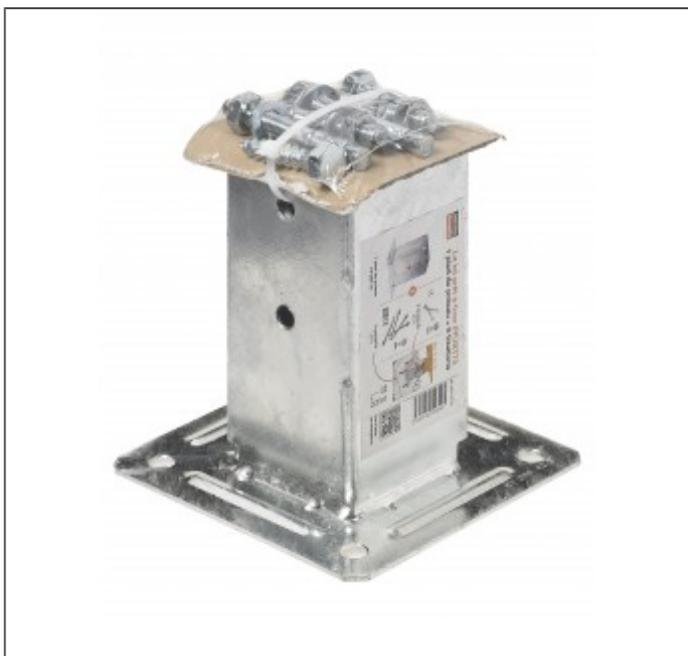
Les pieds de poteau carrés sur platine PPJBT sont préconisés dans la réalisation de petits ouvrages tels que les clôtures et structures légères de jardin. Très faciles à démonter, ils peuvent être boulonnés sur support béton et acier ou visser sur bois.
