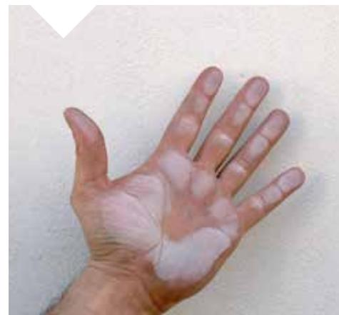
Si, après le nettoyage, le support reste poudreux (passez la main dessus – si elle est blanche le support est poudreux), procédez à une zone test : appliquez la peinture sur une petite surface en suivant les étapes de préparation et d'application recommandées, et grattez après séchage pour vérifier son adhérence.
