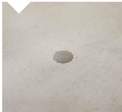
Testez sa porosité avec le «test de la goutte d'eau» : versez une goutte d'eau sur le sol. Si la goutte est absorbée en moins d'une minute, le sol est suffisamment poreux.
