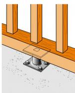
De petite dimension, les petits pieds de poteaux réglables APB7090 sont particulièrement adaptés à la fixation de garde corps ou de planchers chauffants.
