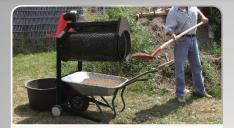
Le tambour est supporté à ses deux extrémités et entraîné par une courroie trapézoïdale à l'arrière, l'ouverture de chargement est ainsi complètement libre.
