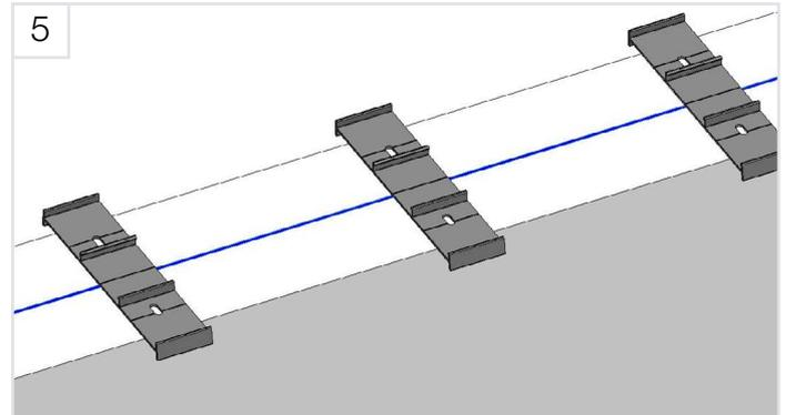
6. Mettre 4 pattes de fixation par barre de 3m10. Positionner la 1ère fixation à 10cm minimum du départ de la couverture. Puis espacer les fixations restantes.
