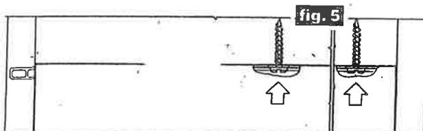
Fixer le profil U sous la rainure à l'aide de vis (fig. 5).
