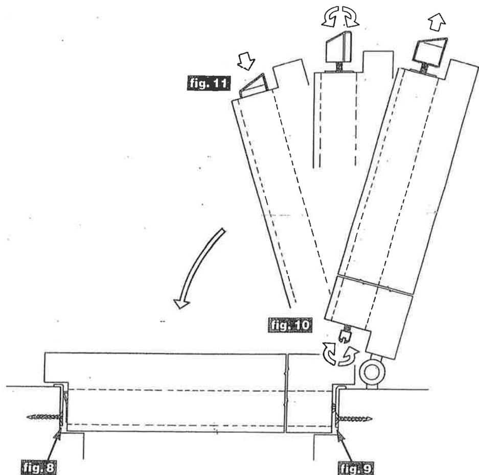
Procéder au réglage, optimal du joint du côté paumelle, en faisant tourner la vis de réglage (fig. 10)
