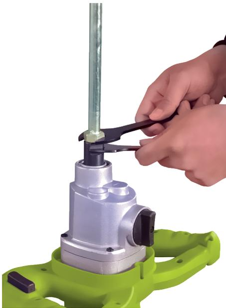
Pour retirer la tige de mélange, dévissez-la de l'arbre d'entraînement. Il se peut que la tige soit bien serrée dans le logement. Dans ce cas, bloquez le logement avec une clé afin qu'il ne tourne pas.
