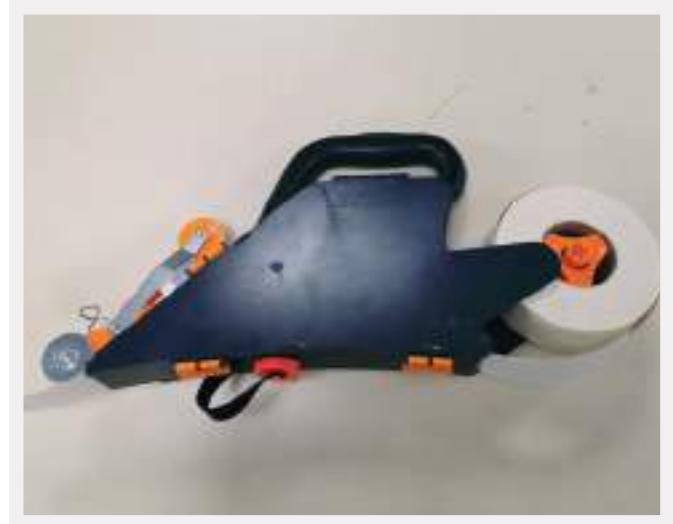
4/ Drehen Sie den Verschluss mit einer  $\frac{1}{4}$  Drehung, dann wird der Kopf freigegeben.
