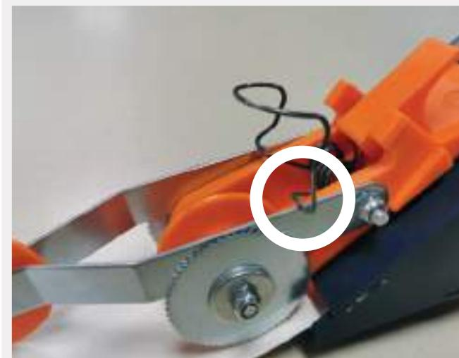
3/ Wenn Sie das Band in einer Ecke anbringen, richtet sich das Rad entsprechend im Eckwinkel automatisch aus.
