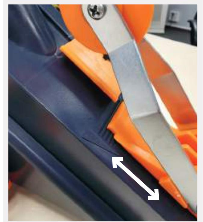
5/ Tirer la bande jusqu'à ce qu'elle soit entièrement recouverte d'enduit.
