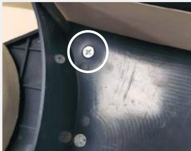
2/ Bohren Sie mit einem Bohrer Ø5,2 in die Vorbohrlöcher.
