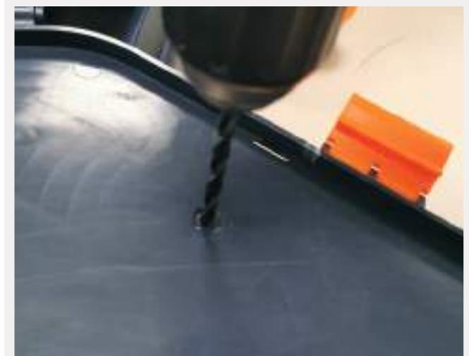
3/ Colocar los ganchos sobre la tapa con los tornillos M5 x 12.
