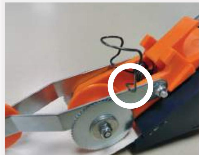
3/ Appliquer la bande, la roue se calera dans l'angle automatiquement.
