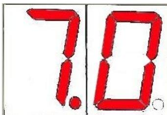
**FR** Appuyer pendant 3 secondes sur le bouton CAL, la valeur 7.0 commencera à clignoter sur le Display. L'étalonnage du pH 7.0 est automatique et il se termine quand la valeur sur le Display redevient fixe
