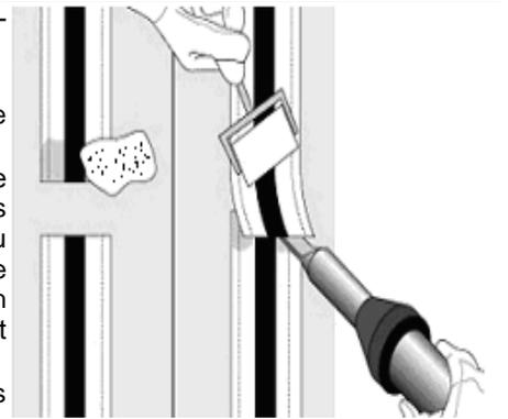
Ne pas souder des parties déjà collées au Sikadur-31 DW : risque de brûler la colle. En cas de bandes existantes (rénovation), le Sikadur-Combiflex® SGT doit préalablement être abrasé avec un papier de verre grain fin puis dépoussiéré avec un chiffon sec.
