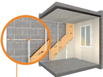
Clipsage de l'appui sur la fourrure intermédiaire
