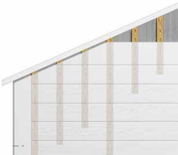
Remarque : Dans la pointe de la bardage dans l'ossature existante (entraxe  $\leq$  600 mm) deux lattes plus courtes sont prévues pour que les côtés inclinés du bardage HardiePlank® peuvent être bien fixés.
